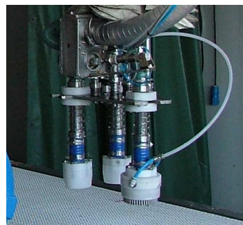
Griper med patentert griperhode
